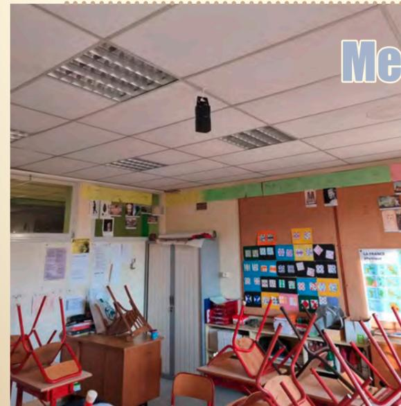
Les mesures de CO2, dans les salles de classe des écoles de la commune sont engagées avec un appareil spécifique qui mesure aussi les formaldéhydes. Les mesures sont effectuées de façon prioritaire dans les salles de classe qui ne sont pas dotées de ventilation mécanique contrôlée et qui sont les plus chargées.
