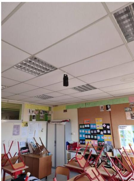
Les mesures de CO<sub>2</sub>, dans les salles de classe des écoles de la commune sont engagées avec un appareil spécifique qui mesure aussi les formaldéhydes. Les mesures sont effectuées de façon prioritaires dans les salles de classe qui ne sont pas dotées de ventilation mécanique contrôlée et qui sont les plus chargées.
